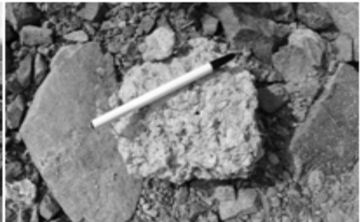
암버력 내 슛크리트 혼입
